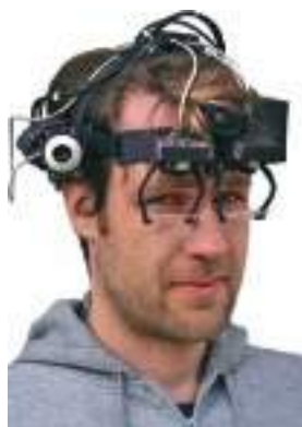
Die EyeSeeCam wurde unter Mitwirkung von Stefan Glasauer 5 entwickelt. Sie misst Augen- und Kopfbewegungen und steuert mit diesen Informationen eine Kamera an der Seite der Apparatur. So kann der Versuchsleiter „mit den Augen der Versuchsperson“ sehen.
